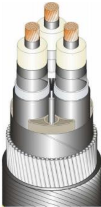
Figur 23. Exempel på sjökabel i genomskärning.
