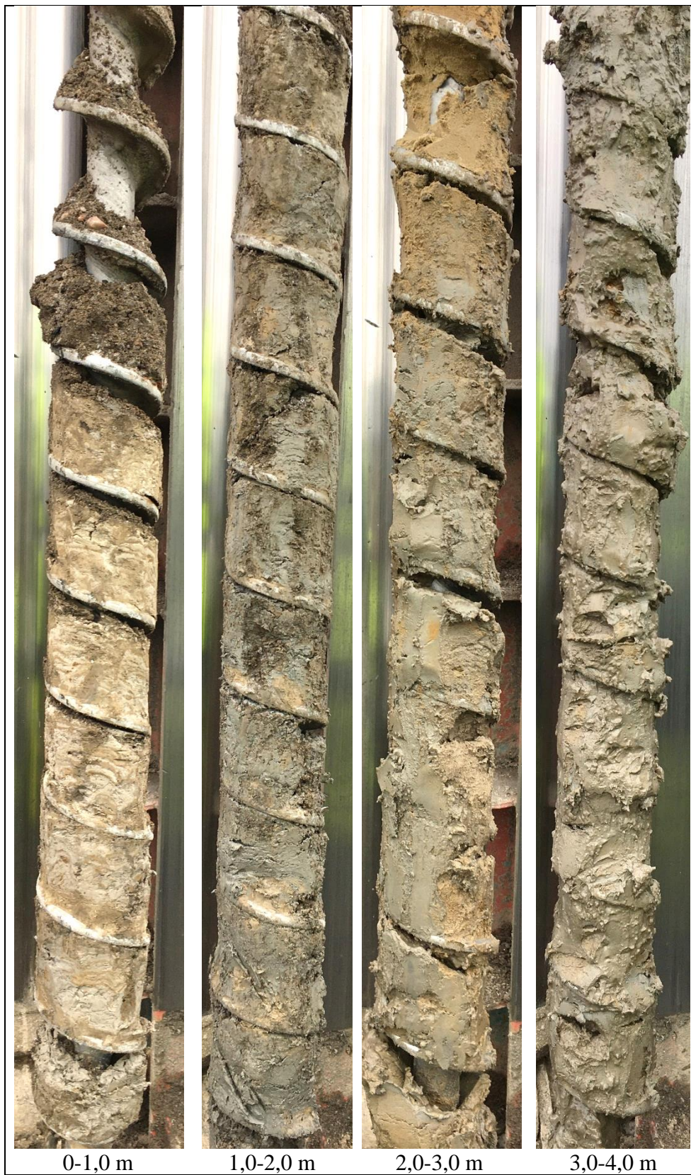
Figur 4. Foton av markprofil på skruvborr i provpunkten BP4
