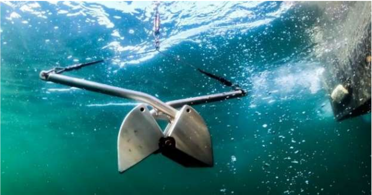
Figur 49. Van Veen provtagare av det slag som används för provtagning av infauna.
